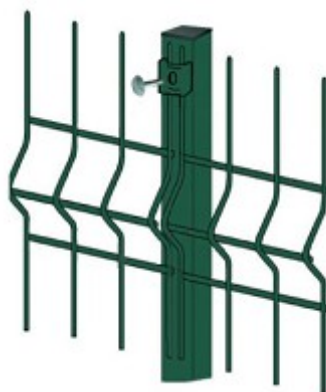
Рисунок 3 – Крепление панелей на стойке
