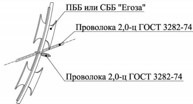
Рисунок 6 – Схема закрепления ограждения «Егоза» на V-образной насадке
